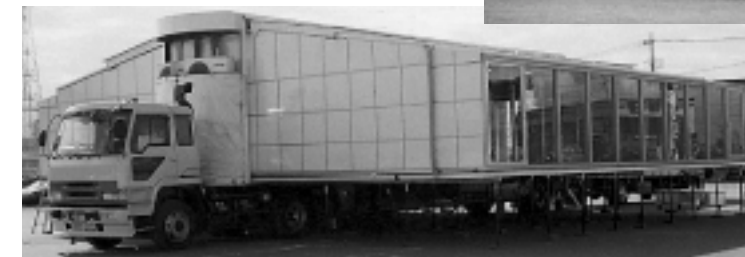
車両としての走行性を維持しながら、空間の可能性を広げていくというコンセプトで作られた車両。用途に合わせた大きさで空間を展開。写真の車両は、総床面積が約50坪あり、イベント会場としての活用が可能
