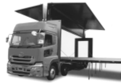
車両としての走行性を維持しながら、空間の可能性を広げていくというコンセプトで作られた車両。用途に合わせた大きさで空間を展開。写真の車両は、総床面積が約50坪あり、イベント会場としての活用が可能
