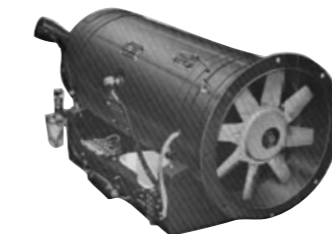
1960年に製造販売された日本初のバス用独立燃焼式エンジンプレウォーマーヒーター
