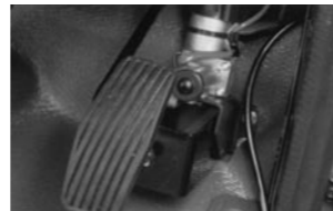
モーター式アクセルインター ロック アクセルペダルを固定することでアクセル操作を不能にし、車両発進を防ぐ装置
