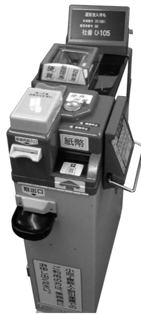
最近の主流である整理券のバーコードやカードの乗車情報から運賃を瞬時に算出、自動的に清算する「即時計数式運賃箱」
