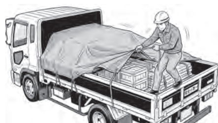
荷台のあおりに立ってのシート掛け作業は転落事故の原因となっている
