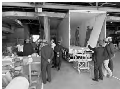
札幌ボデー工業 パネル組立工程
