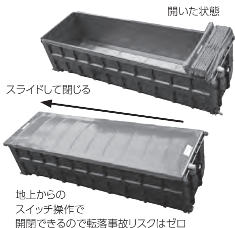
荷台のあおりに立ってのシート掛け作業は転落事故の原因となっている
