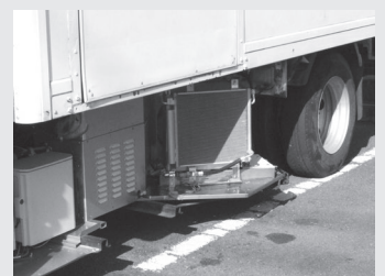
実証実験用の試作機 1時間の高速道路走行で約1kwhを発電
