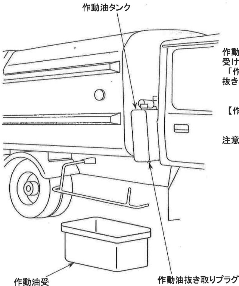
作動油タンクの下に十分な容量の作動油受けを入れ、作動油タンクの下面にある「作動油抜き取りプラグ」を取外し作動油を抜き取って下さい。
