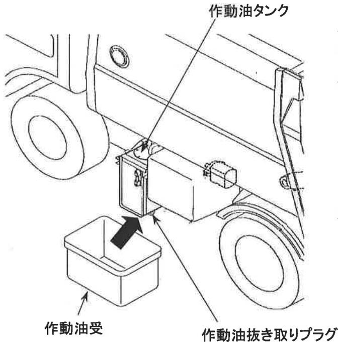
作動油タンクの下に十分な容量の作動油受けを入れ、作動油タンクの下面にある「作動油抜き取りプラグ」を取外し作動油を抜き取って下さい。
