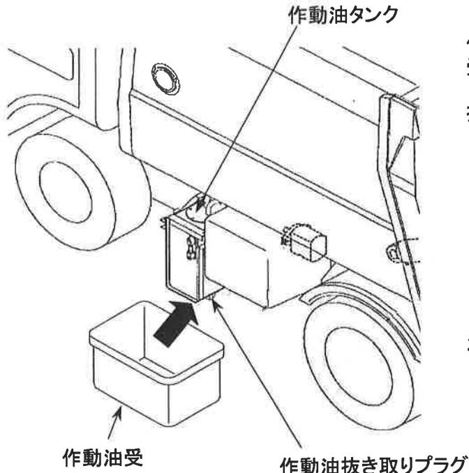
作動油タンクの下に充分な容量の作動油受けを入れ、作動油タンクの下面にある「作動油抜き取りプラグ」を取り外し作動油を抜き取って下さい。
