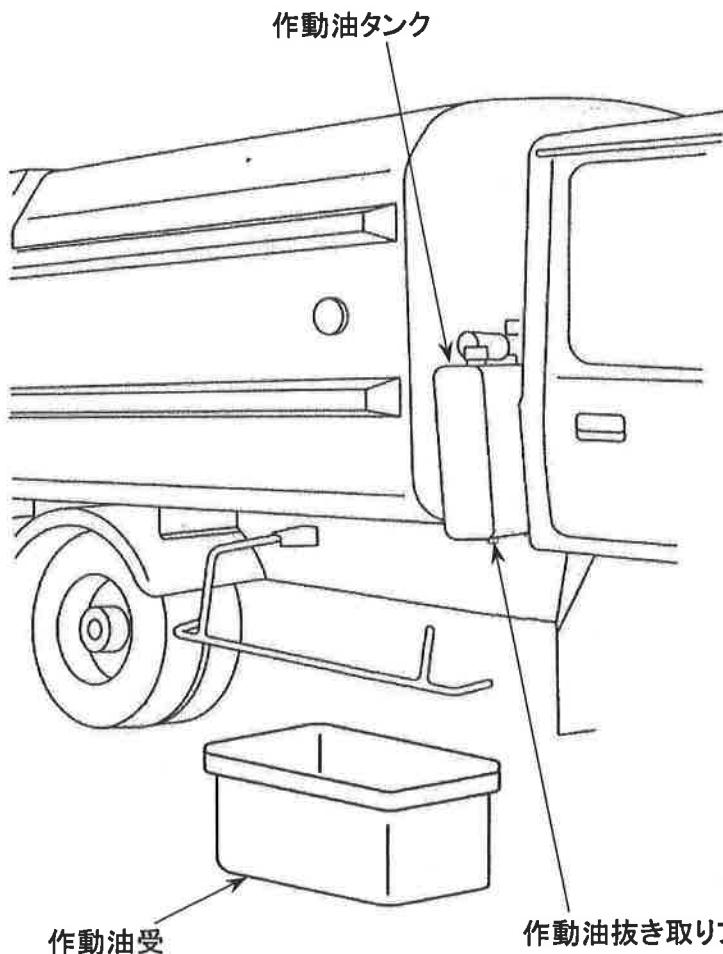
作動油タンクの下に充分な容量の作動油受けを入れ、作動油タンクの下面にある「作動油抜き取りプラグ」を取り外し作動油を抜き取って下さい。
