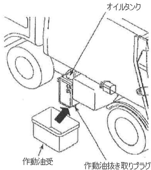
オイルタンクの下に十分な容量の作動油受けを入れ、オイルタンクの下面にある「作動油抜き取りプラグ」を取り外し作動油を抜き取って下さい。
