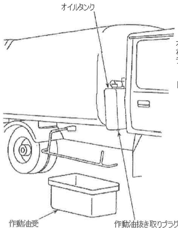
オイルタンクの下に十分な容量の作動油受けを入れ、オイルタンクの下面にある「作動油抜き取りプラグ」を取り外し作動油を抜き取って下さい。
