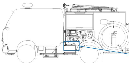
側板に取付けられている各ドレンバルブをひねり排水処理を行ってください。
