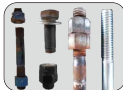
締結ボルト伸び・摩耗・折損
