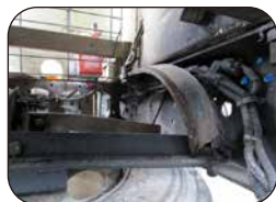
締結部敷きベルトのずれ
