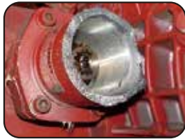
【P.T.O ポンプ直結式破損】
