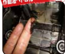
作動油ヘドロ化(劣化)...
