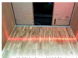
後端からの転落防止のため赤色で警告する照明
