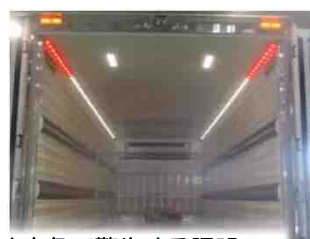
後端からの転落防止のため赤色で警告する照明
