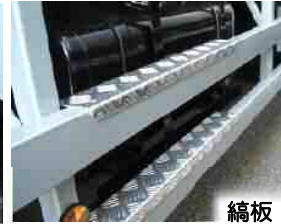
バーリング加工&鋼板固定式
