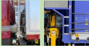
【前廻り梯子滑り止め工作】 滑り止めテープ張り 縞板張り
