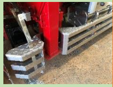
【サイドガード 滑り止め工作】 縞板張り
