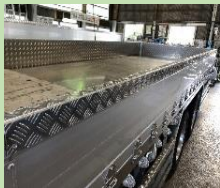
上部縞板張り
