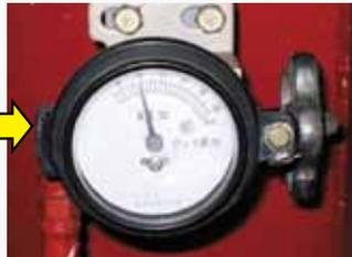
試験装置でダンプに荷重を加えて、荷重計の数値にダンプ自重計の数値を調整します
