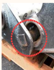
プレート連結ボス部の異常摩耗
