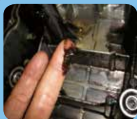
パワーユニット作動油劣化
