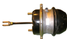
ブレーキ・チャンバ (スプリング・チャンバ部(非分解型のみ))
