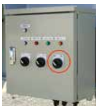
コンテナ集中ロック操作スイッチ。上が運転席スイッチ、右がコンテナ設置スイッチ。円内が「開放/緊定」選択ボタン。
