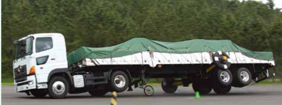
トレーラ ROC の装着効果を検証した走行試験。ROC を装着していないトレーラが時速 60km で障害物を避けるため右側にレーンチェンジした際のもよう。トレーラ左側の車輪が大きく浮き上がっています。
