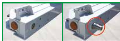
トラクタ運転席またはトレーラに設置した操作スイッチの「開放/緊定」ボタンを「緊定」に切り換えると前後の緊定装置を一括してロック。左側がロッキングピン(前側緊定装置)、右側がツイストロック(後側緊定装置)。それぞれ右の円内がロック状態。
