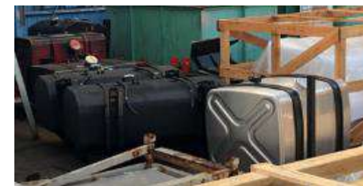
車両から取外された燃料タンク
