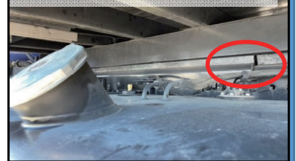
シャシスペーサーずれ
