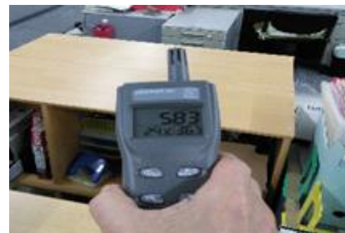
<室内環境の測定（CO 2 計）>
