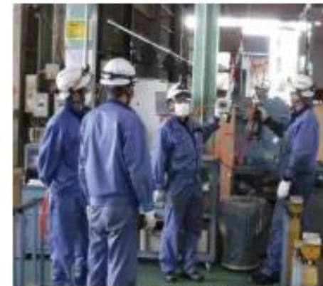
生産ラインが停止している静かな時間を利用して、漏れ箇所を確認しています
